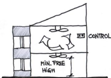
Il sistema è composto da un **ventilatore a soffitto che regola automaticamente la sua velocità**, secondo la temperatura e l'umidità della stanza. I dati verranno raccolti dai sensori e inviati all'unità di controllo da remoto. Le informazioni sulla condizione della stanza sono quindi processate dall'algoritmo che controlla il ventilatore.
